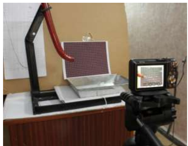
Рис. 3. Визначення швидкості частин мінеральних добрив з використанням методу визначення координат
