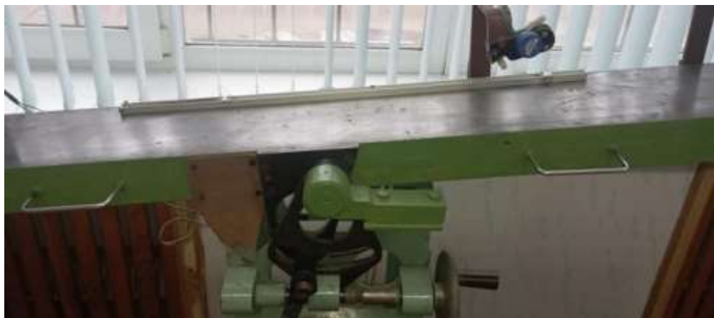
Рис. 2. Схема до визначення фрикційних характеристик зерна і струн Дупеета із застосуванням приладу Желіговського.
