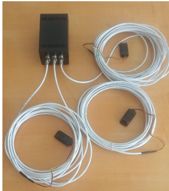
Рис. 2. Загальний вигляд пристрою моніторингу параметрів мікроклімату тваринницьких приміщень з датчиками температури
